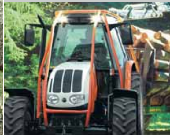
Forst-Spezialkabine* mit verjüngtem Dachbereich.
