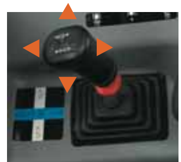
STEYR-Kreuzschalthebel* zur Betätigung von zwei mechanischen und einem elektro-magnetischen Zusatzsteuergerät.
